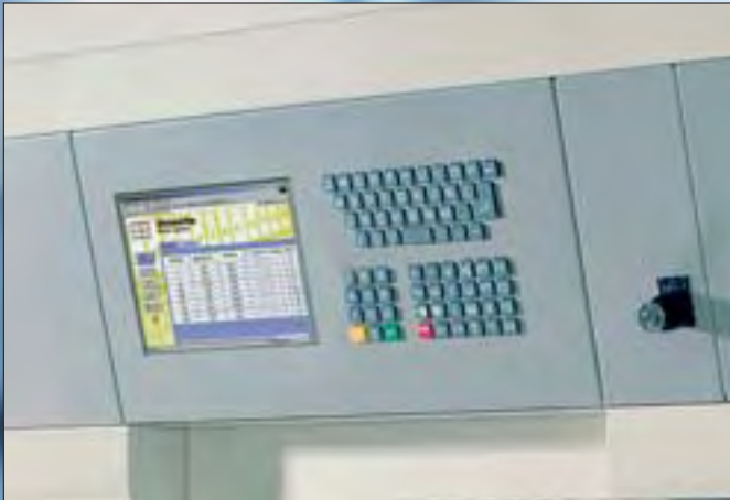
Hänel MP 12 N-S top styring med touchscreen teknologi
